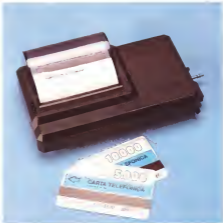
La PXP40 stampa in 80 colonne su carta termica; il rullo è protetto da un coperchio di plastica e lateralmente sporge il jack per la connessione al PXT000F.
